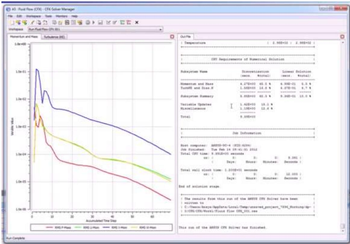
Figura 23: Módulo CFX-SOLVER – ANSYS WORKBENCH – versão acadêmica (ANSYS, 2016).
