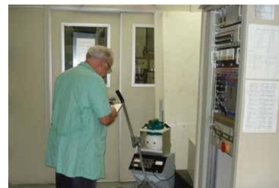
Levantamento radiométrico durante operação do ciclotron do IEN/CNEN.
