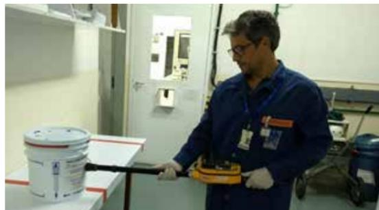
Monitoramento do radiofármaco embalado para classificação de risco e despacho terrestre e aéreo.
